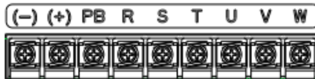
Hình 3-7: 3PH Terminal mạch chính (30-37kW)
