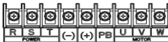
Hình 3-7: 3PH Terminal mạch chính (30-37kW)
